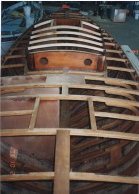
Changement du capot de descente et des panneaux d'écouille avant et arrière.
